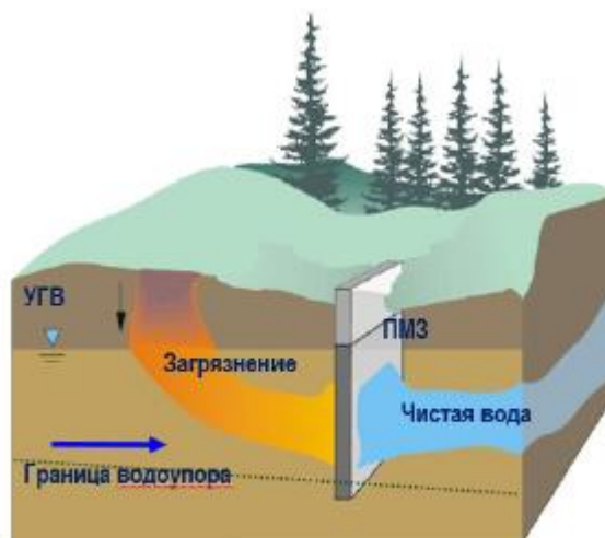
Рисунок 1.4.2.2 Схематичное изображение противомиграционной завесы
