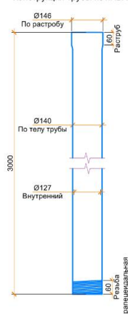
Конструкция трубы из нПВХ
