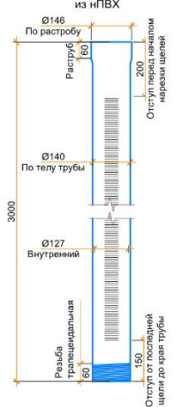
Конструкция щелевого фильтра из нПВХ
