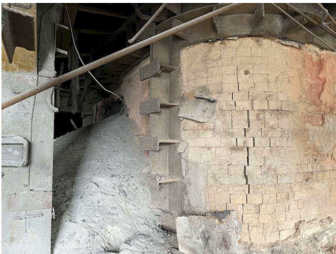
Ёмкость усл.№243 – печь обжига карбида кальция
