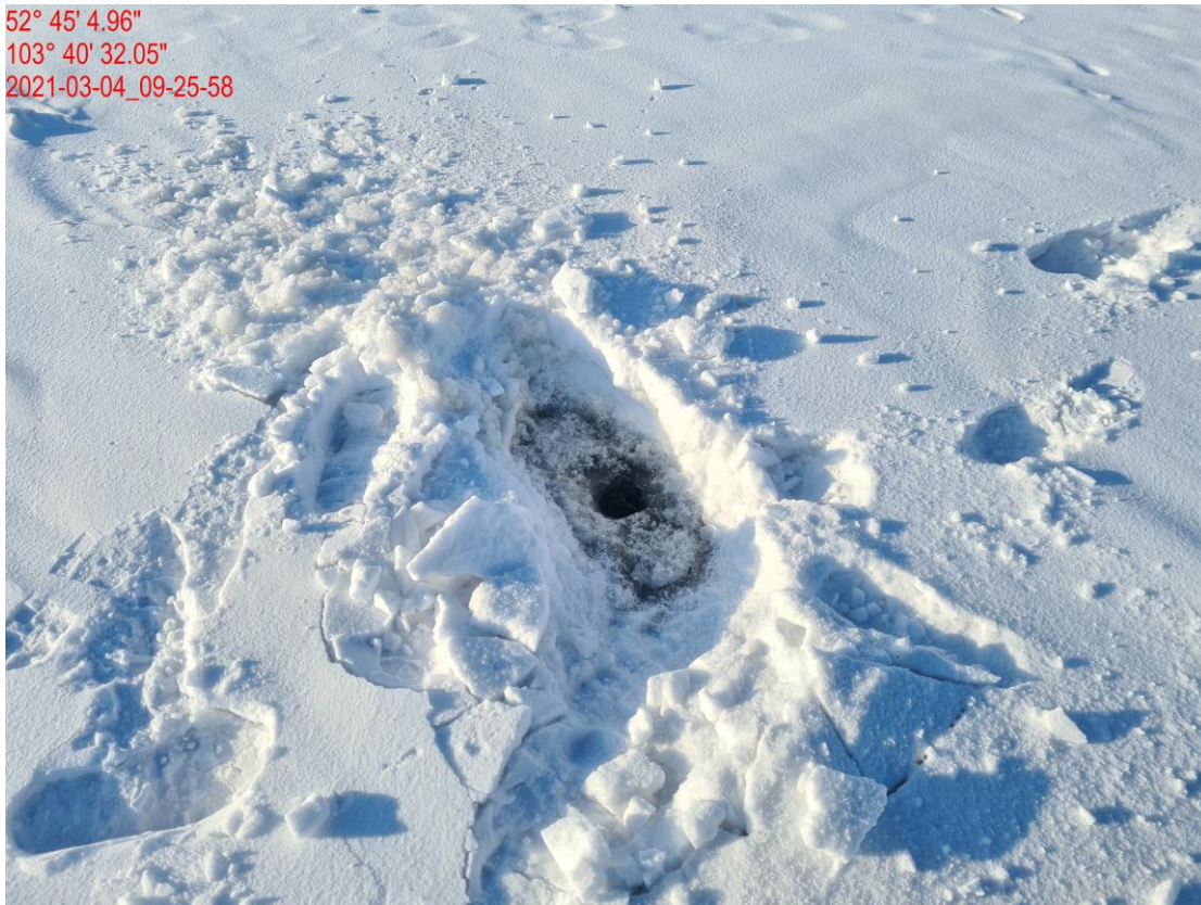
Рисунок Д3 Бурение лунок для определения уклона водной поверхности
