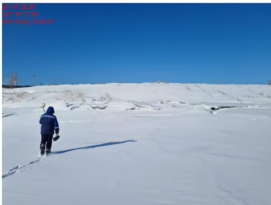
Рисунок Д6 Поиск и нивелирование меток УВВ
