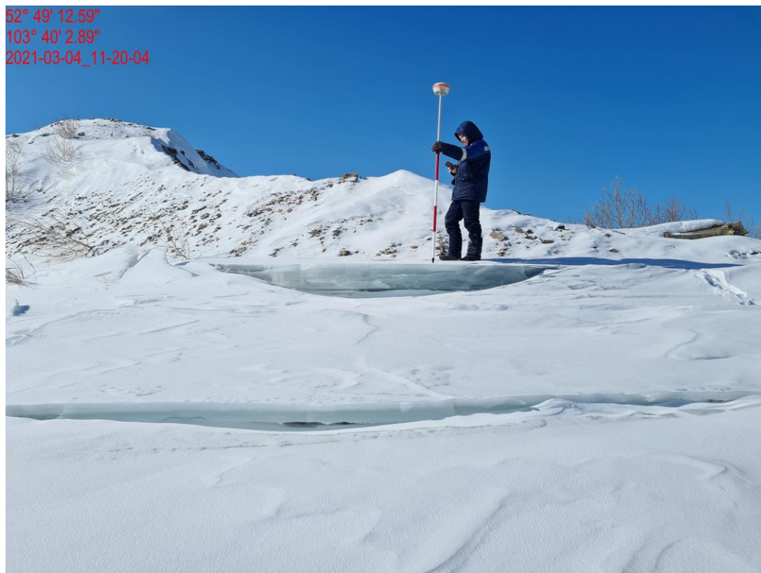
Рисунок Д5 Поиск и нивелирование меток УВВ
