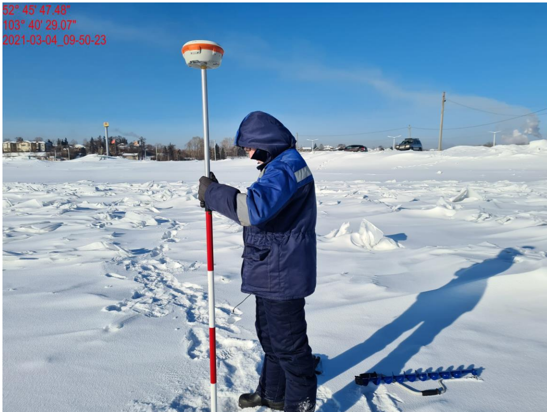
Рисунок Д4 Определение уклона водной поверхности
