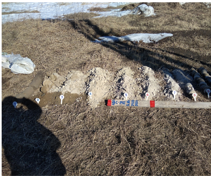
Рисунок 4.2.2 – Отбор грунтов из геологических скважин
