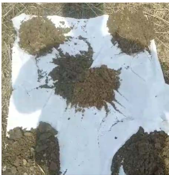
Рисунок 4.2.1 – Метод отбора поверхностный почв (грунтов) методом конверта
