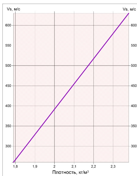
Рисунок 2.3. Эмпирическая зависимость между скоростями поперечных V_s сейсмических волн и средневзвешенными значениями плотностей 30 метровой толщи ( V_s=f(\rho) )
