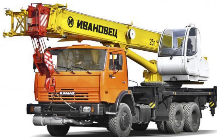
Автомобильный кран КС-45717К-1, грузоподъемностью 25 т для работы с обычными грузами и грузоподъемностью 20 т для работы с ядовитыми и взрывоопасными грузами, смонтирован на шасси КАМАЗ-53215, 53229, 65115 (6 x 4).
