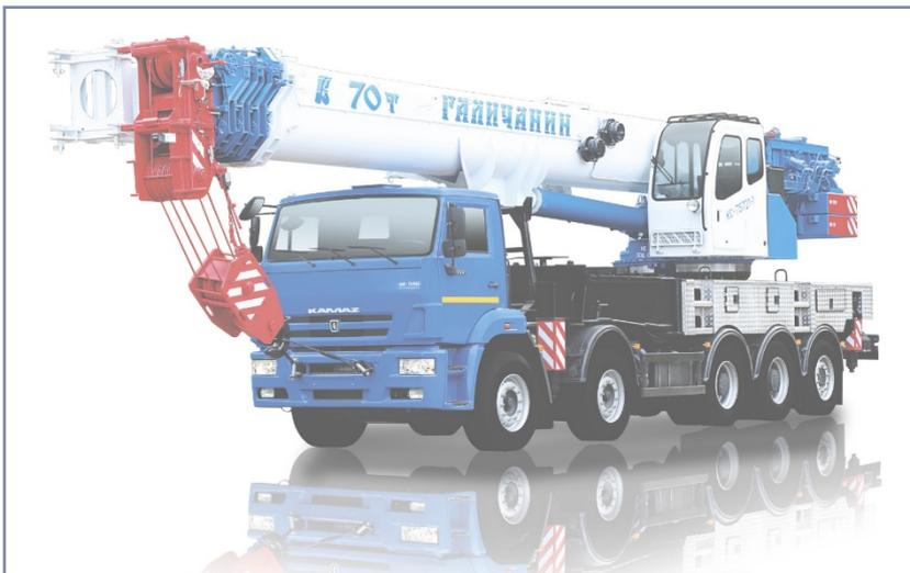
Н&Н - система LS-привода производства HYDAK (Германия) с электропропорциональным управлением крановыми операциями при помощи многофункциональных джойстиков и прибора безопасности фирмы HIRSCHMANN (Германия) с бесступенчатым регулированием защиты крана от перегрузки при работе.
