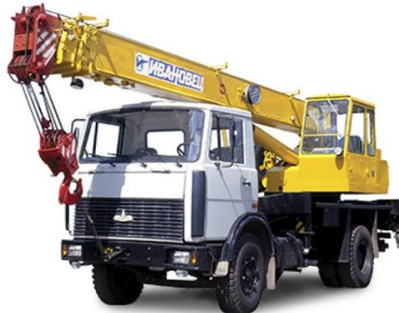
Автомобильный кран КС-35715, грузоподъемностью 16 т, смонтирован на шасси МАЗ-5337А2 (4 х 2).
