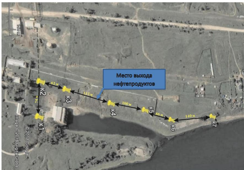
Рисунок 1.3.1.2 – Схема трассировки дренажного трубопровода и место выхода нефтепродуктов на территории водозабора "Ангара"
