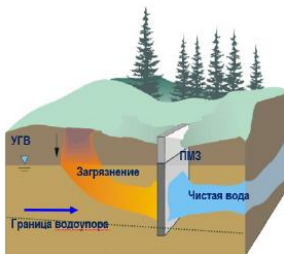
Рисунок 1.4.2.2 Схематичное изображение противомиграционной завесы
