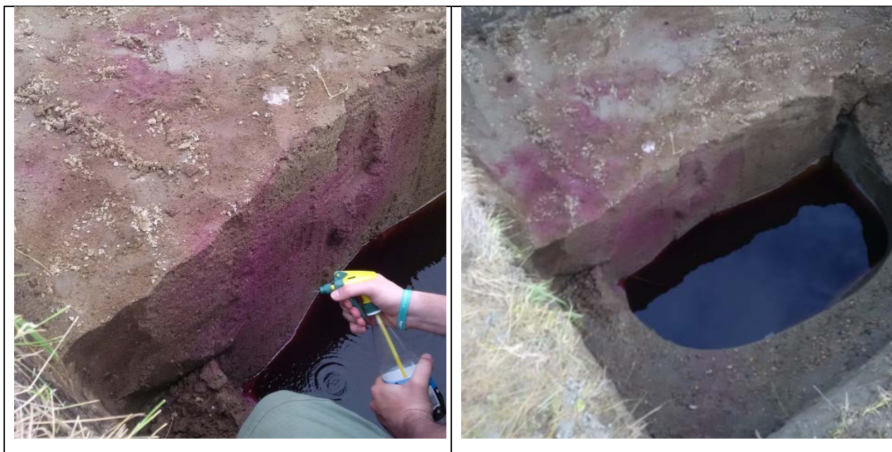
фото 3 Демонстрация противодиффузионных свойств тампонированного массива
