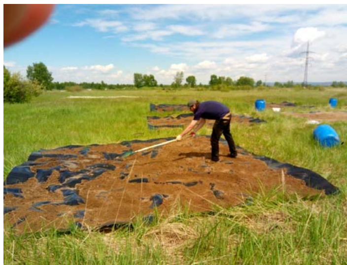
фото 4 Процесс подготовки песчано-гелевого материала высокой проницаемости
