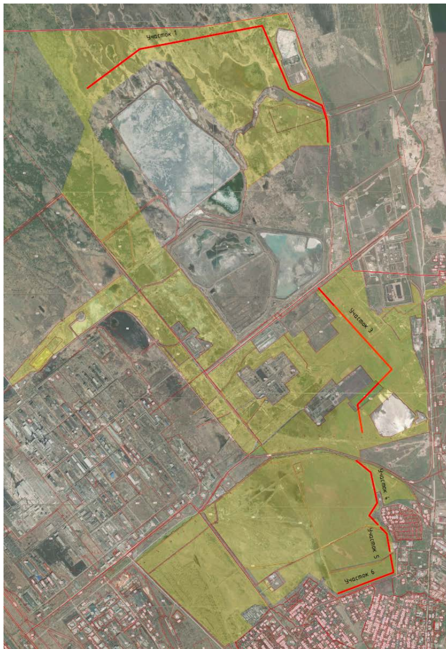
Рисунок 1.6.2. Схема расположения противомиграционной завесы высокой сорбционной способности высокой проницаемости
