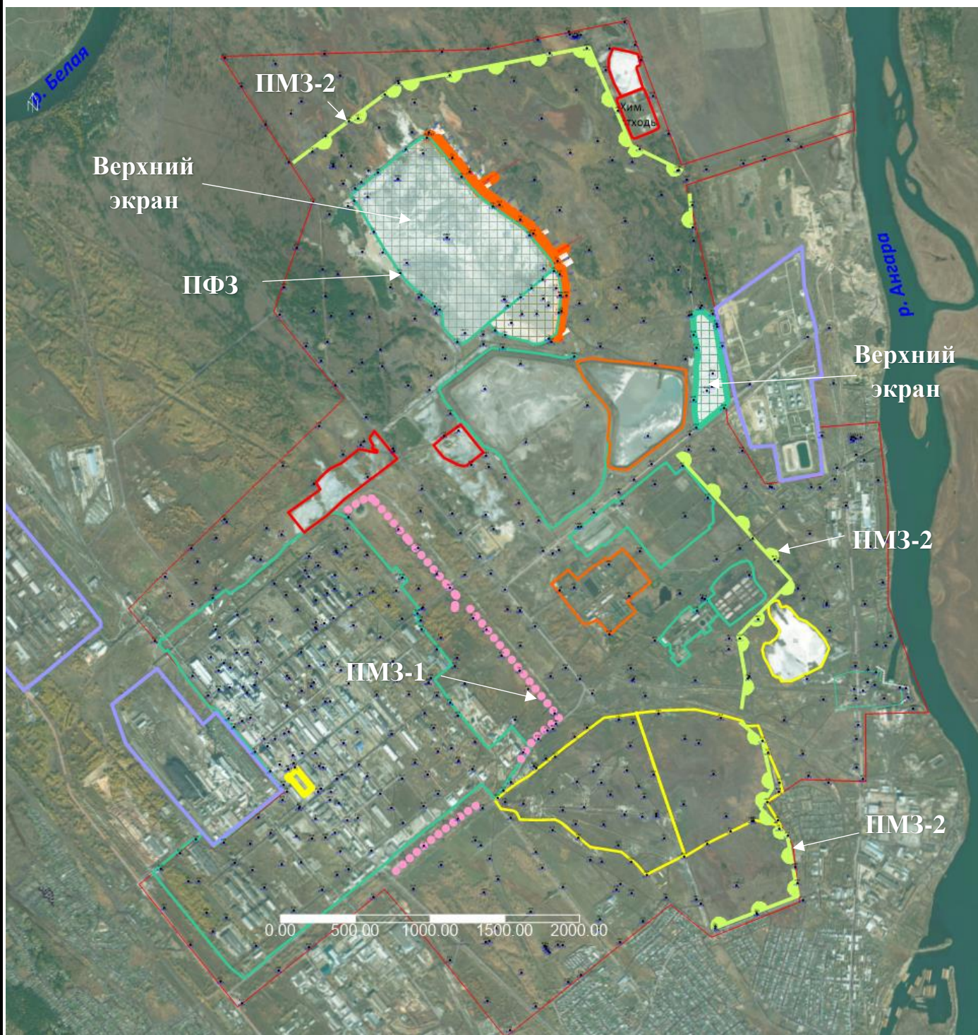
Рис.9.1 Карта с положением основных мероприятий, предполагаемых проектными решениями (ООО “Геотехпроект”) для ликвидации накопленного вреда. Условные обозначения к подложке представлены на рис. 8.2.
