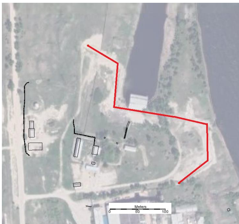
Рис.5.5. Схема задания на модели шпунтового ограждения (контур шпунта - красная линия).
