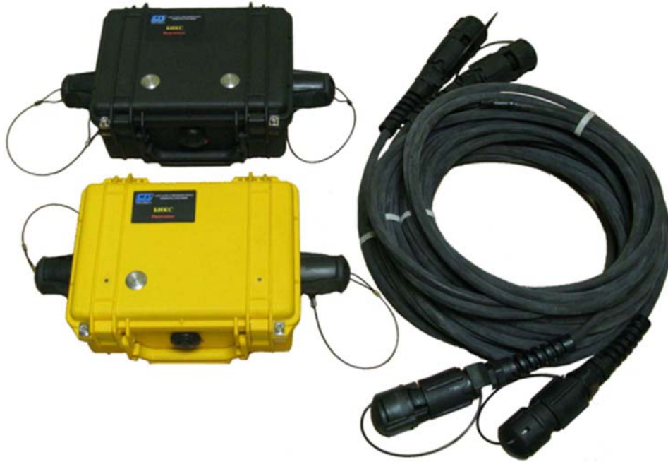
Рис. 2.1 Внешний вид комплекта аппаратуры «БИКС». Генератор, приемник, емкостные шлейфы
