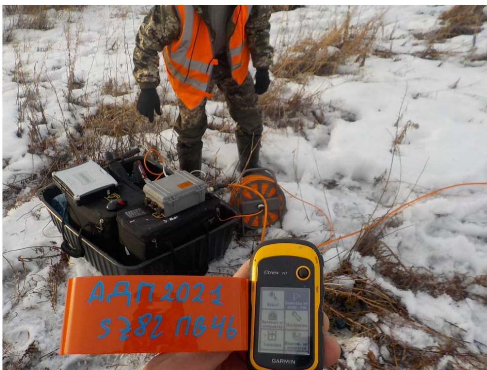
Рисунок 2.3. Работа на сейсмостанции «ЛАККОЛИТ X-М3»
