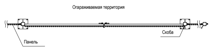
Узел IV. Схема монтажа металлических гильз под шпингалеты ворот
