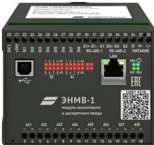
Рисунок 4.3.2 ЭНМВ-1-8X8/8 на 8 ТС и 8 ТИ 4...20 мА
