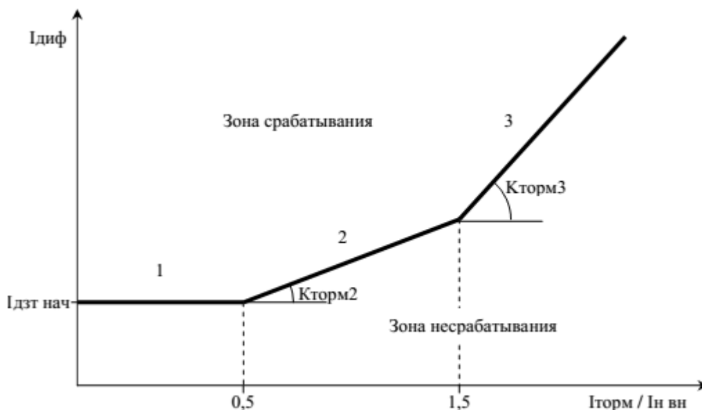
Рисунок 3.1 - Характеристика срабатывания ДЗТ
