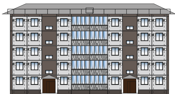
места установки кондиционеров
