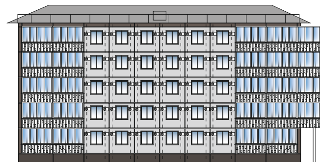
места установки кондиционеров
