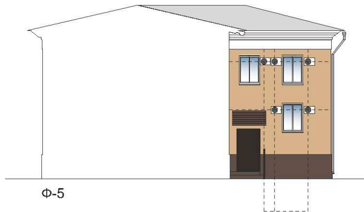
места установки кондиционеров
