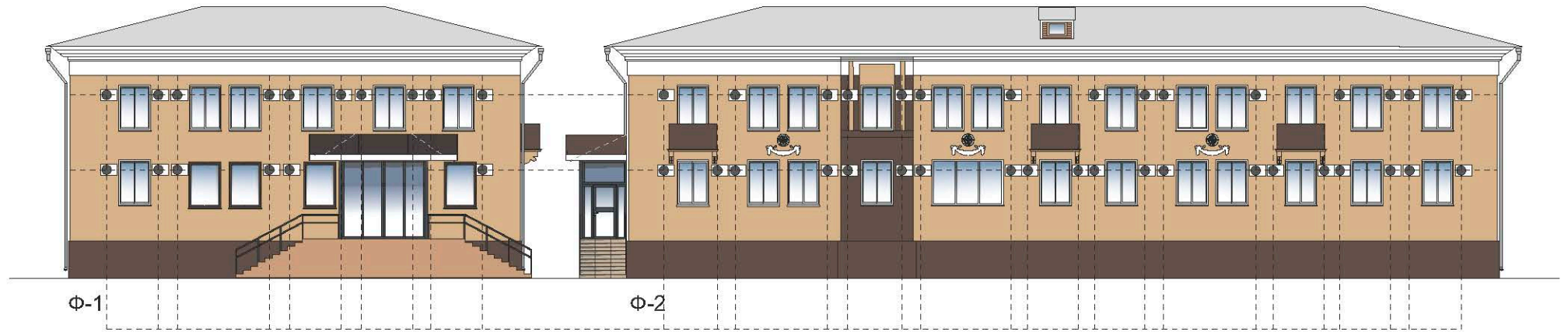
места установки кондиционеров
