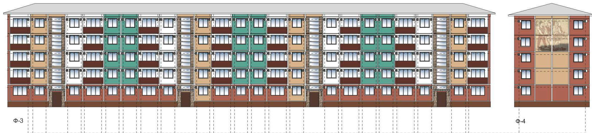
места установки кондиционеров
