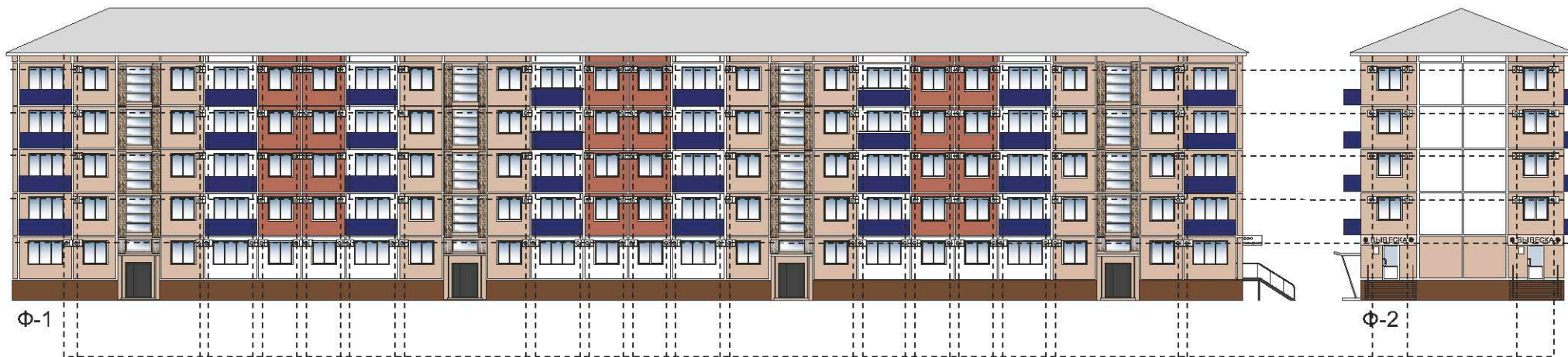
места установки кондиционеров
