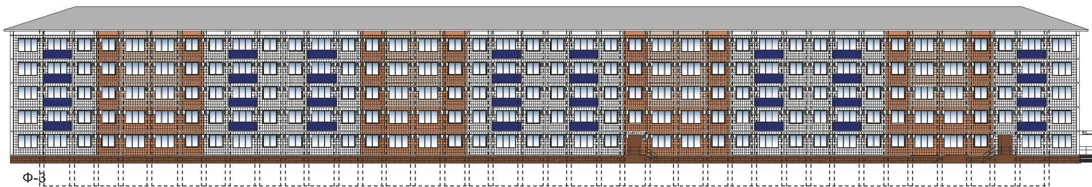
места установки кондиционеров
