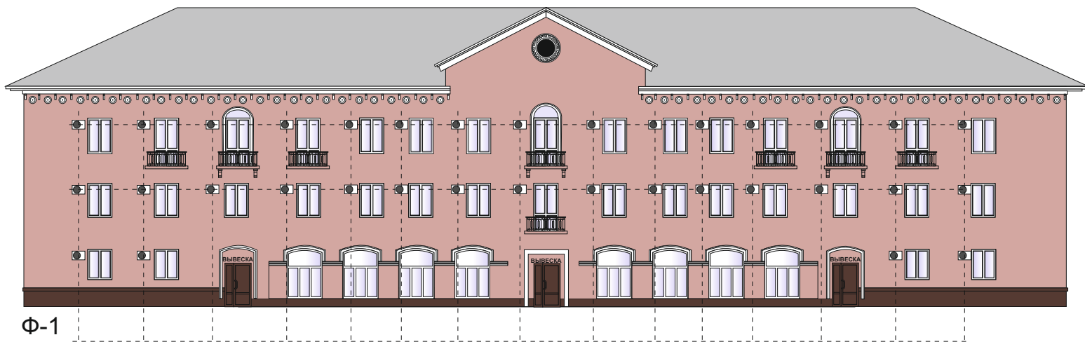
Ф-1 места установки кондиционеров
