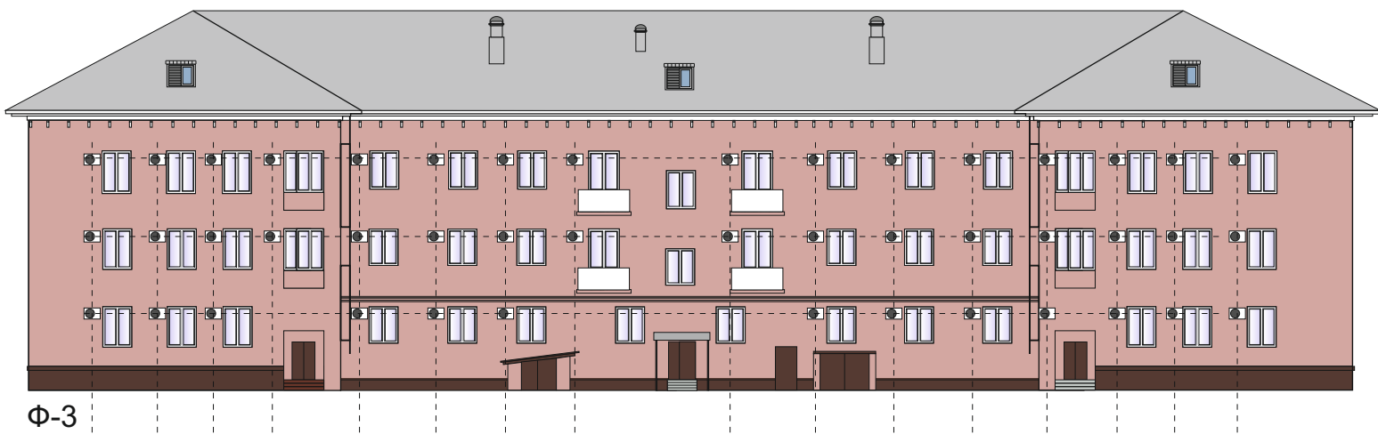
Ф-3 места установки кондиционеров
