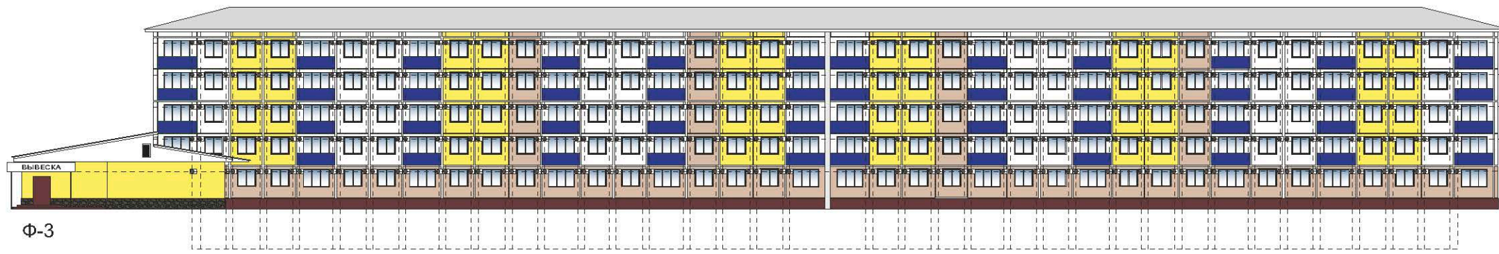
места установки кондиционеров
