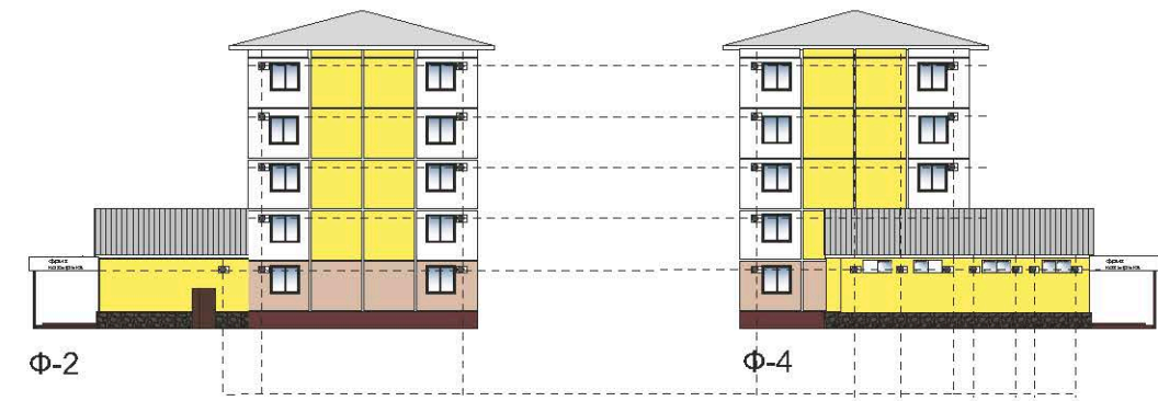
места установки кондиционеров
