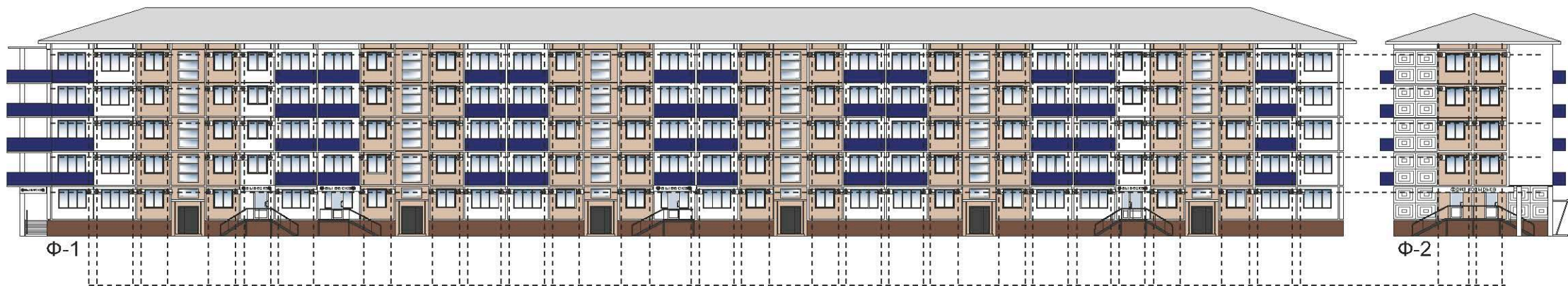
места установки кондиционеров
