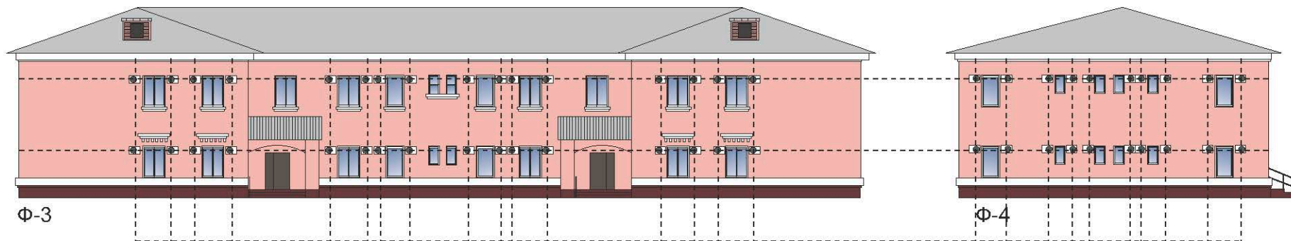
места установки кондиционеров
