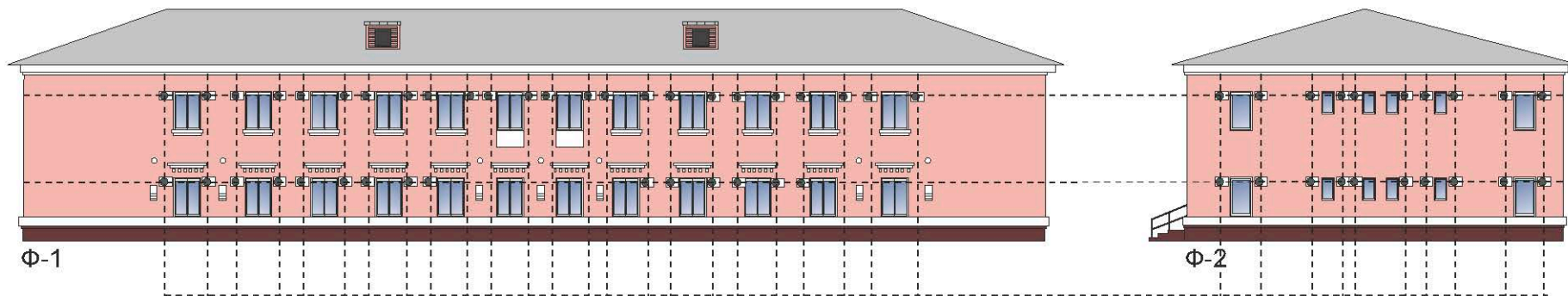
места установки кондиционеров
