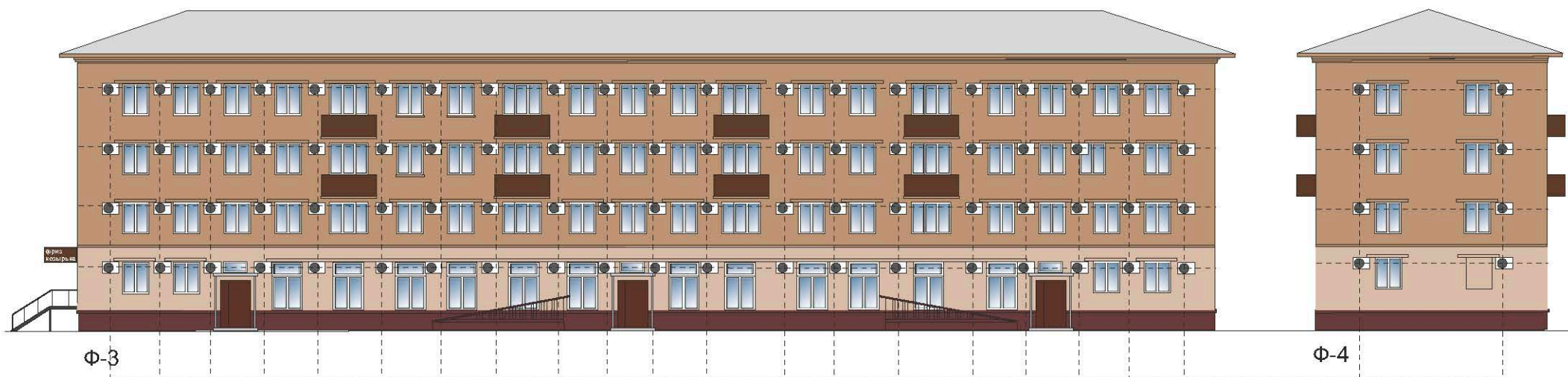
места установки кондиционеров
