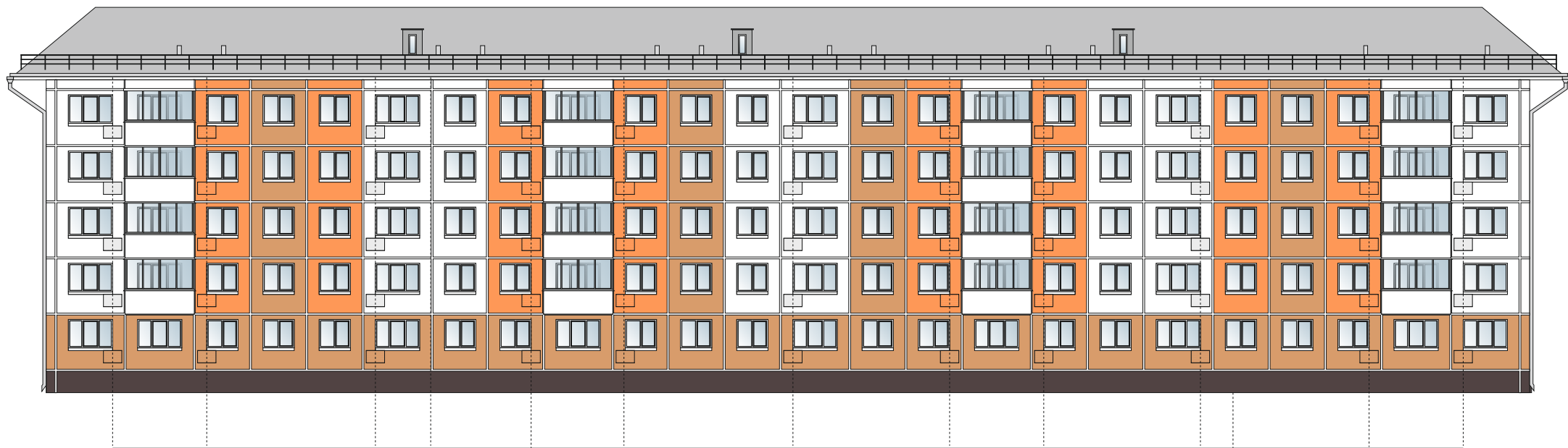
Размещение блоков кондиционеров в корзинах
