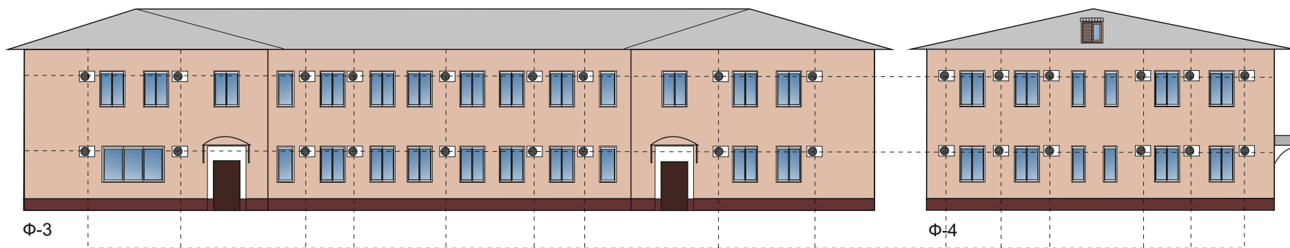
места установки кондиционеров
