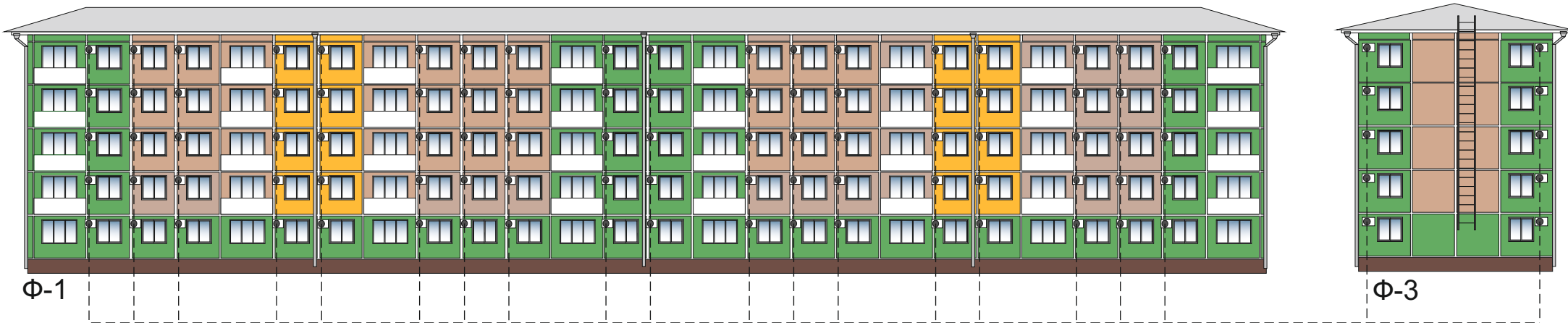
места установки кондиционеров
