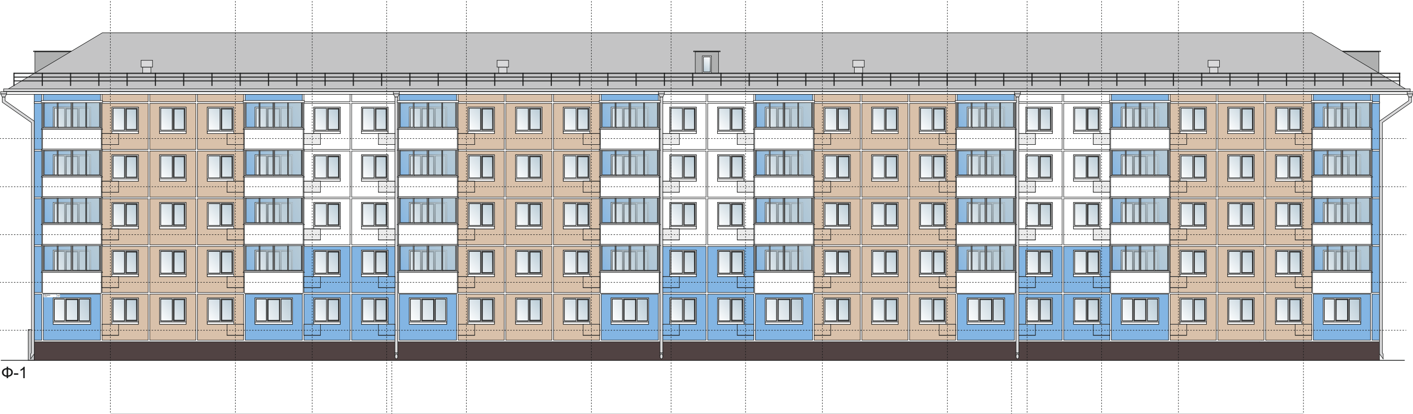
Размещение блоков кондиционеров в корзинах
