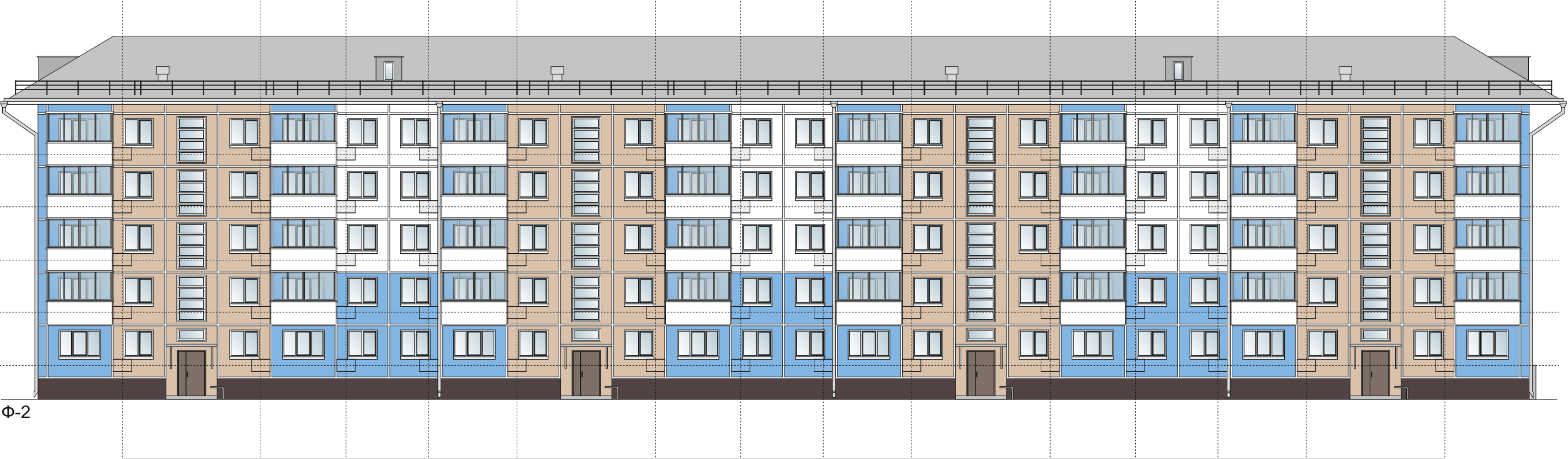
Размещение блоков кондиционеров в корзинах
