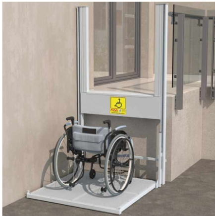
Вертикальный подъемник для инвалидов, рассчитанный на подъем до 2х метров. Грузоподъемность, кг – 250 Высота подъема, м – 2 Ширина подъемного механизма, мм – 1100 Габаритные размеры площадки, мм – 1030 x 1040
